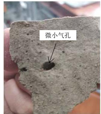
图5 EHP工法桩芯样剖面
