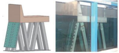
图1 桩基透空式防波堤
